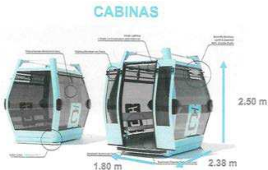
Figura 4.4 Dimensiones orientativas de la cabina de 10 plazas.
